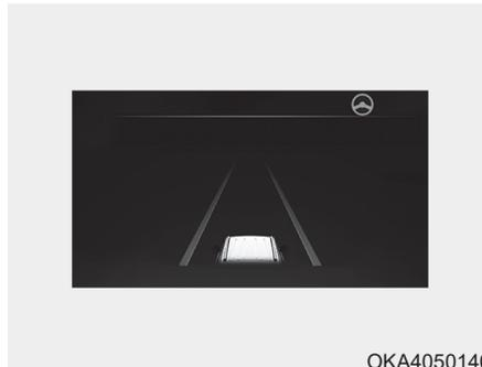
Se o veículo à frente e/ou ambas as marcações de faixa forem detectadas e a velocidade de seu veículo for inferior a 180km/h, a luz indicadora verde (🟢) acenderá no painel e a função ajudará o veículo a permanecer na faixa, auxiliando a direção.
