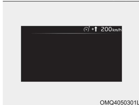
Se o limite de velocidade da via mudar durante a utilização do Assistente Manual para Limite de Velocidade ou do Piloto Automático Inteligente, uma seta para cima ou para baixo é exibida para infor-
