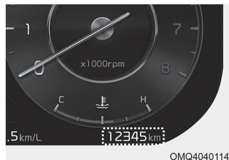
O odômetro indica a distância total que o veículo já percorreu, e pode ser utilizado para determinar quando as revisões periódica devem ser feitas.
