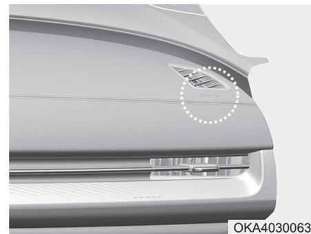
Seu veículo está equipado com um sistema de Airbags (SRS) e cintos de segurança de três pontos tanto para o motorista quanto para o passageiro. As indicações da presença desse sistema é a palavra "AIRBAG" gravada nas coberturas dos alojamentos dos airbags, que ficam no volante e no painel à frente do passageiro, logo acima do porta-luvas.
