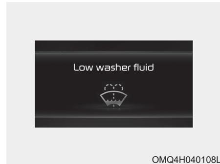
Esta mensagem de aviso acende se o nível de fluido do limpador do para-brisa no reservatório estiver baixo. Adicione fluido do limpador no reservatório.
