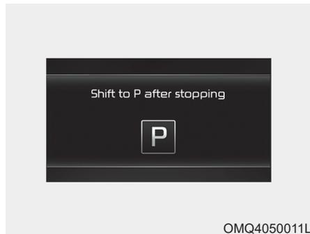
A mensagem é exibida no visor de LCD quando a marcha é alterada para P (Estacionamento) com o veículo ainda em movimento. Pare o veículo antes de engatar a marcha P (Estacionamento).
