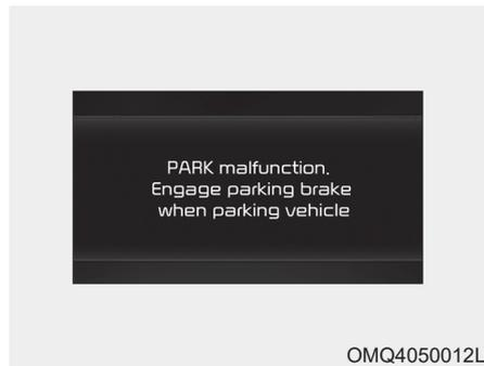
A mensagem é exibida quando há alguma anomalia com a função envolvendo a posição P (Estacionamento). Tenha o veículo inspecionado por uma Concessionária Kia imediatamente.
