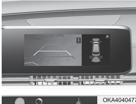
Você pode alterar as configurações do Monitor de Visão Traseira pressionando o ícone de configuração (⚙️) na tela enquanto a função estiver operando, ou selecionar 'Driver Assistance (Assistência para o Condutor) → Parking Safety (Segurança para Estacionamento) → Camera Settings (Configuração da Câmera)' no menu Configurações com o botão de partida/parada do motor na posição ON (ligado).
