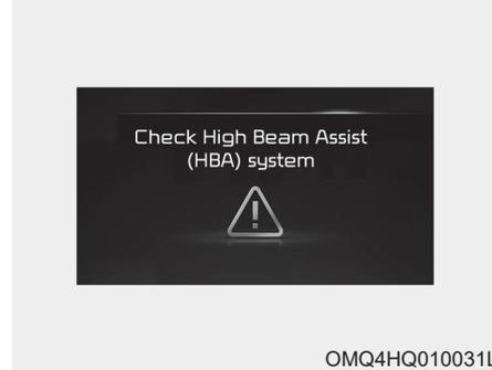
Se o Auxiliar para Farol Alto não estiver funcionando adequadamente, a mensagem de aviso 'Check High Beam Assist (HBA) system (Verifique o sistema do Auxiliar para Farol Alto (HBA))' será exibida e a luz de aviso (⚠) acenderá no painel de instrumentos. Recomendamos que a função seja verificada por uma Concessionária Autorizada Kia.
