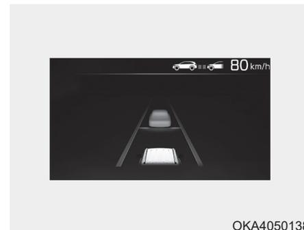
Se você quiser acelerar temporariamente com o Piloto Automático Inteligente ligado, pise no pedal do acelerador. Enquanto a velocidade está aumentando, a velocidade definida, o nível de distância e a distância do alvo piscarão no painel.
