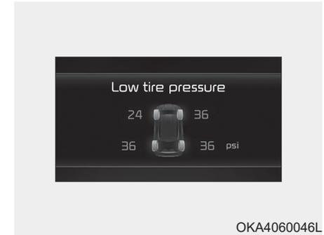
Quando os indicadores de aviso do sistema de monitoramento de pressão dos pneus acendem e a mensagem de aviso é exibida no visor de LCD, um ou mais pneus está com a pressão significativamente baixa. O indicador de posição do pneu com pressão baixa irá indicar qual pneu está com a pressão significativamente baixa, acendendo a luz correspondente à posição do pneu.
