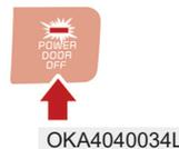
Quando o indicador LED do botão LIG/DESL da porta elétrica está na posição DESLIGADO, a porta deslizante elétrica e a tampa traseira elétrica podem ser controladas através dos botões do subcontrole localizado no revestimento da coluna central ou na tampa traseira. Além disso, as portas podem ser abertas e fechadas automaticamente puxando-se a maçaneta interna ou externa da porta.
