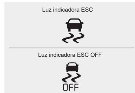
Quando o botão de partida/parada do motor é ligado, a luz indicadora acende, depois apaga se o sistema ESC estiver funcionando normalmente.
