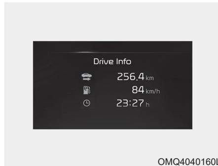
A tela exibe o odômetro, o consumo de combustível e o tempo de condução. Essas informações são exibidas por alguns segundos quando o veículo é desligado e, então, apaga automaticamente. As informações são calculadas para cada vez que o veículo é ligado.
